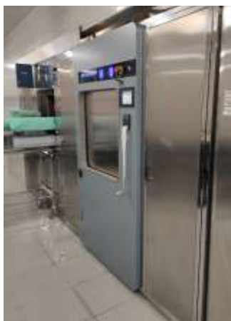
Esterilizadora de vapor
